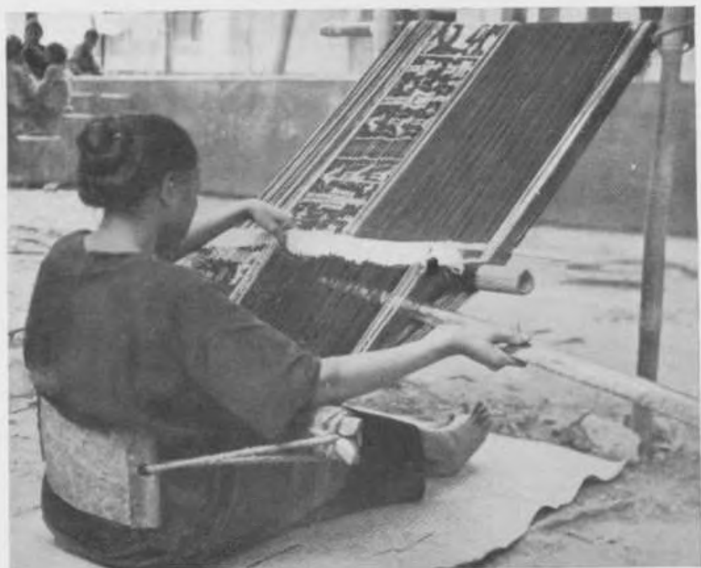
59 Die aufgezogenen ebenen Kettenfäden mit dazwischen geschobener Leiste
