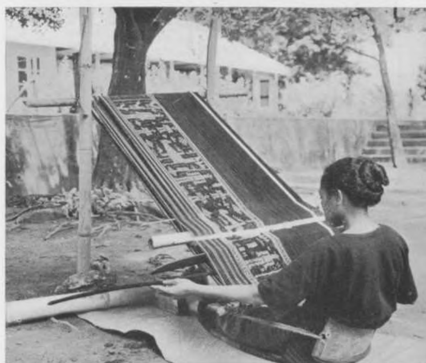
58 Die Spule mit dem Einschlagfaden wird durch die Kettenfäden geworfen
